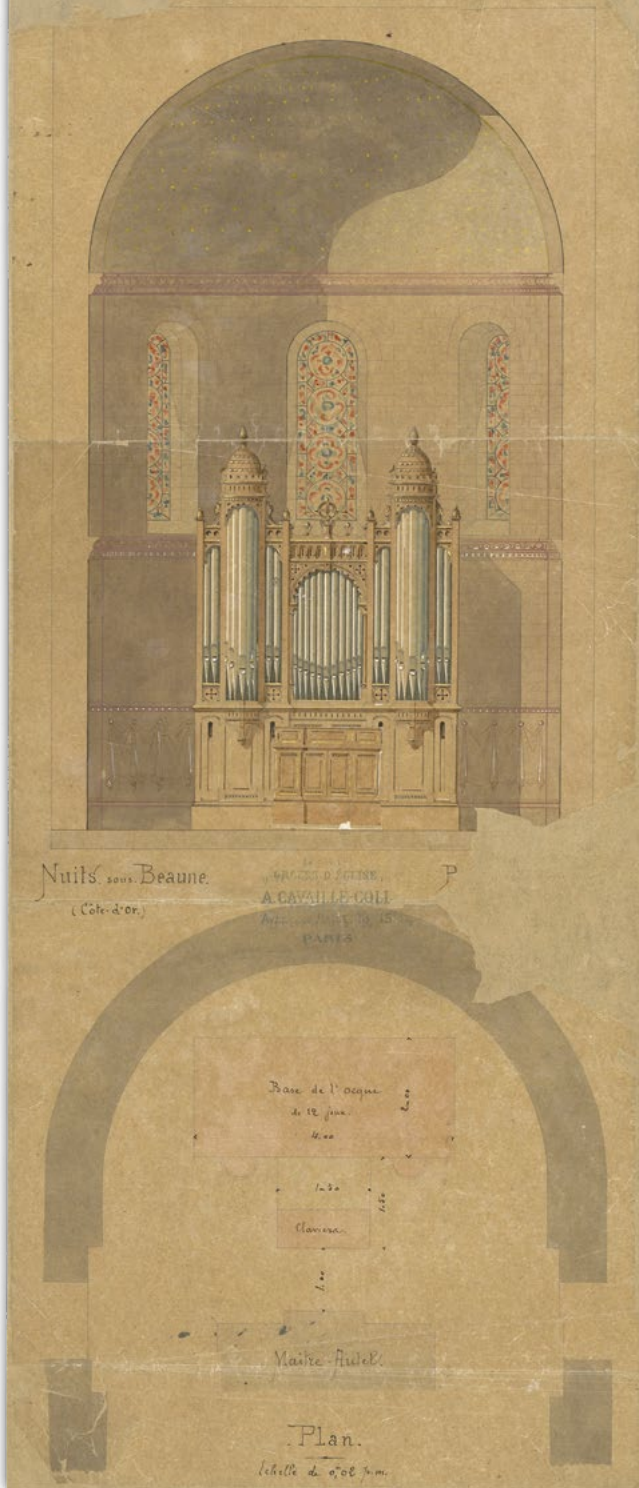
Élévation et implantation du buffet proposé le 2 septembre 1875 pour l'orgue de 12 jeux (Calque restauré)
